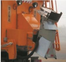
撒布器车辆移动或保管时撒布器向上折叠，可清空料仓余料
