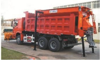
带有自卸支腿，配合底盘的自卸功能，不需要吊装设备即可完成设备的拆装
